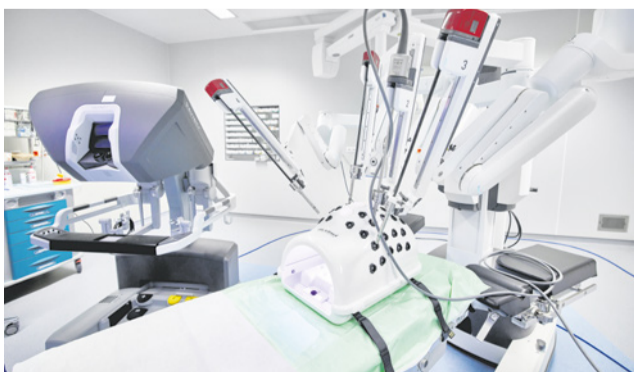
Über eine Konsole (links) werden die Roboterarme des da Vinci-Roboters (rechts) vom Chirurgen gesteuert.
